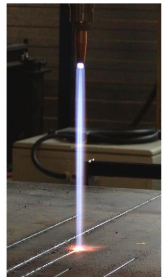
Silny strumień tlenu tnącego z dyszy rozbieżnej: zdjęcie z testów wewnętrznych Koike dyszy 106-D7#0 umieszczonej 275 mm nad blachą.
